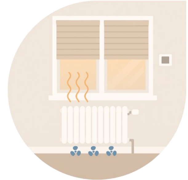
3) innov. Abgabsysteme (Lüfterunterstützte Radiatoren)
