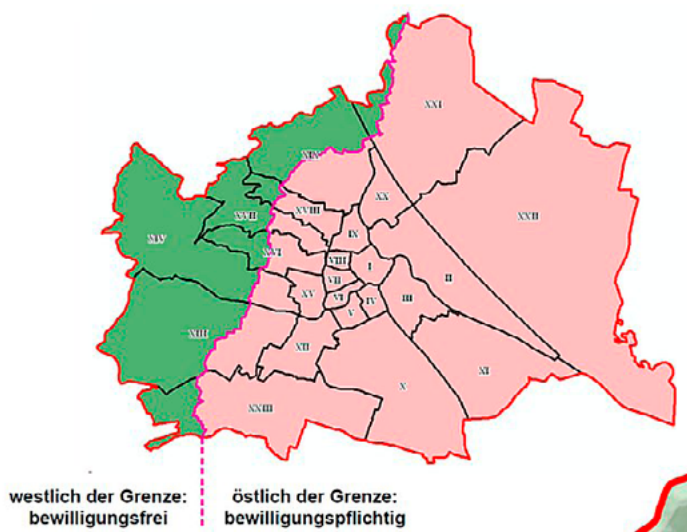
Abbildung 2: Bewilligungspflicht für Tiefensonden. Im Westen von Wien ist der Einsatz von Erdwärmesonden wasserrechtlich bewilligungsfrei. Im restlichen Wien ist hingegen eine wasserrechtliche Bewilligung notwendig.
